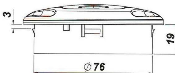
Diffuseur avec support de rotation et adaptateur de gaine (diamètres possibles : 40 mm, 45 mm, 50 mm, 55 mm, 60 mm) / air louver with rotation support and duct adapter (possible diameters: 40 mm, 45 mm, 50 mm, 55 mm, 60 mm) :
