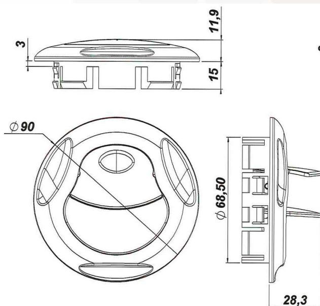
Diffuseur avec support de rotation / air louver with rotating support :
