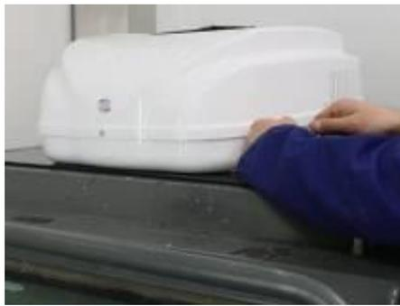
2. Placer le SKIMO sur le toit puis le fixer par l'intérieur de la cabine avec les 4 vis M8 et leurs rondelles enlevées dans l'opération de préparation.
