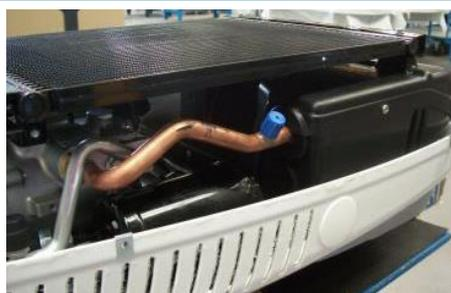
9. Remonter le couvercle du bloc évaporateur et l'ensemble condenseur avec les vis d'origine.
