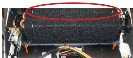
6. Enlever les crochets de maintien du bulpren sur la face supérieure de l'évaporateur. Retirer le bulpren en le dégageant en sous face de l'évaporateur.
