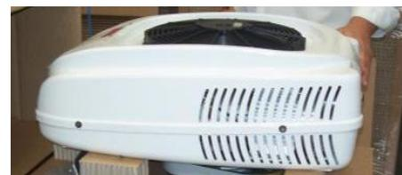
10. Remonter le couvercle de l'unité à l'aide des vis d'origine en ayant au préalable connecté le ventilateur.
