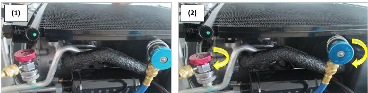
Les manomètres **HP** et **BP** indiquent la pression dans le circuit A/C.
