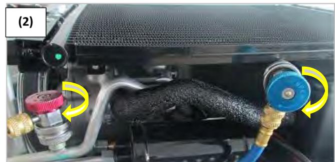
**Note :** Les manomètres **HP** et **BP** indiquent la pression dans le circuit A/C.
